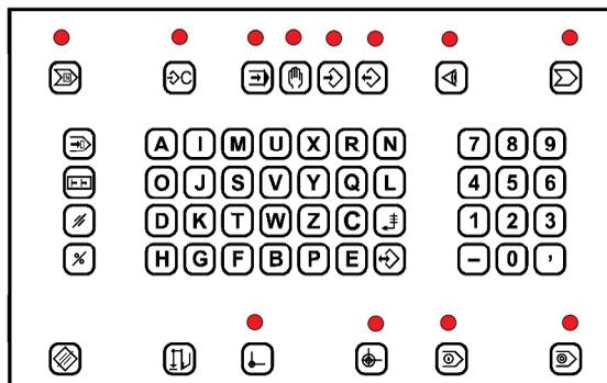
Рисунок 5.6 – Внешний вид передней панели Модуля ПУ-2Р22
