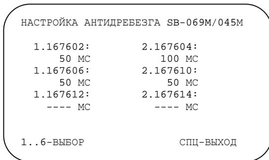
Рисунок 4.14 – Настройка длительности переходных процессов («дребезга») по входам
