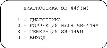
Рисунок 4.28 -Выбор режима диагностики внешних плат управления приводом
