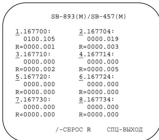
Рисунок 4.32 - Диагностика внешних плат оцифровки датчиков
