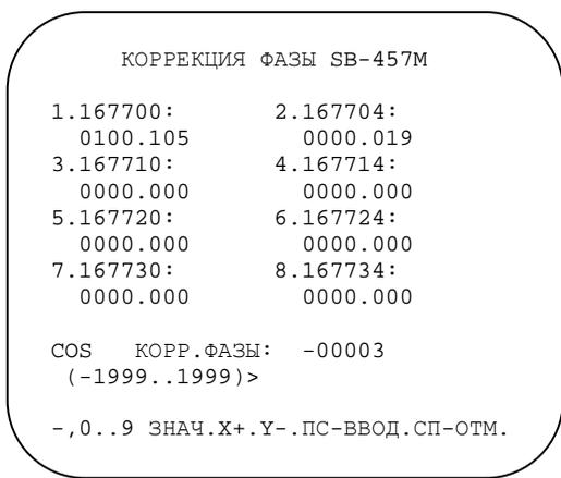
*Рисунок 4.34 – Настройка коррекции фазы выбранного канала SB-457M*
