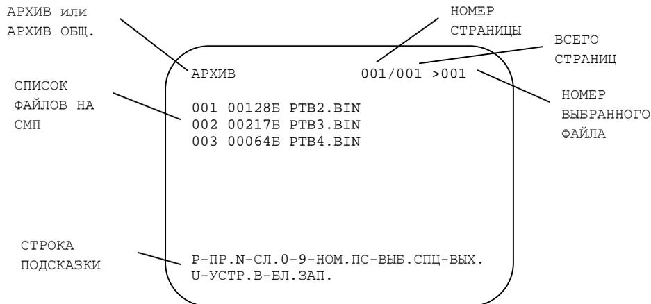
Рисунок 7.2 - Экран работы с сетевым архивом
