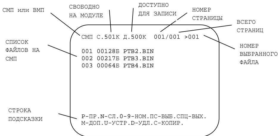
Рисунок 7.1 – Экран работы с модулем памяти
