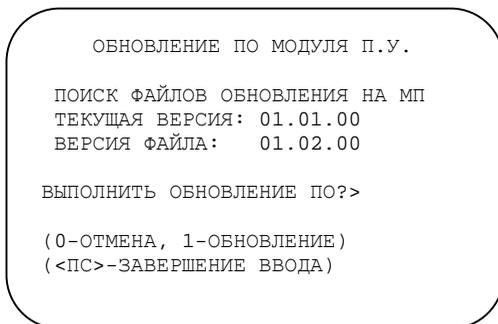
*Рисунок 4.19 –Обновления прошивки программного обеспечения модуля БОСИ*
