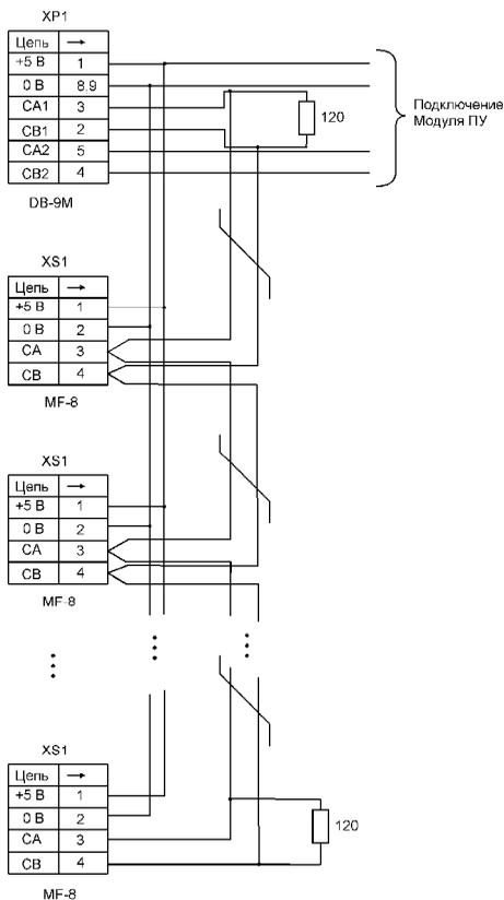
Рисунок 6.1 –Интерфейсный кабель для подключения внешних модулей
