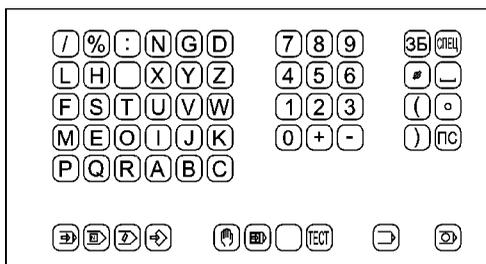
Рисунок 5.1 - Внешний вид передней панели Модуля ПУ-2С42, исполнение 1
